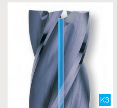
SIRIUS-Fräser mit zentral stirnseitig austretendem Kühlkanal
